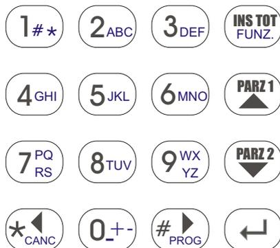
I tasti numerici ( da 0 a 9 ) vengono usati per digitare i codici di accesso, necessari per entrare in programmazione ( tecnico o utente ) o per inserire / disinserire.
