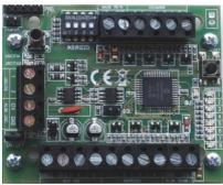
**Concentratore** è l'espansione di ingressi e uscite che permette di aumentare il numero di zone per un impianto più ampio. E' dotato di 8 ingressi bilanciabili e 2 uscite in O.C. programmabili. La scheda dispone di morsetti di alimentazione per sensori e uscite singolarmente protetti da corto circuiti con fusibili ripristinabili. Inoltre è disponibile un sinottico a led per monitorare lo sbilanciamento delle zone senza necessariamente ricorrere alla tastiera o al pannello della centrale.
