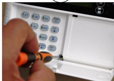
Aiutandosi con un cacciavite a croce svitare la vite di fissaggio del coperchio al fondo.
