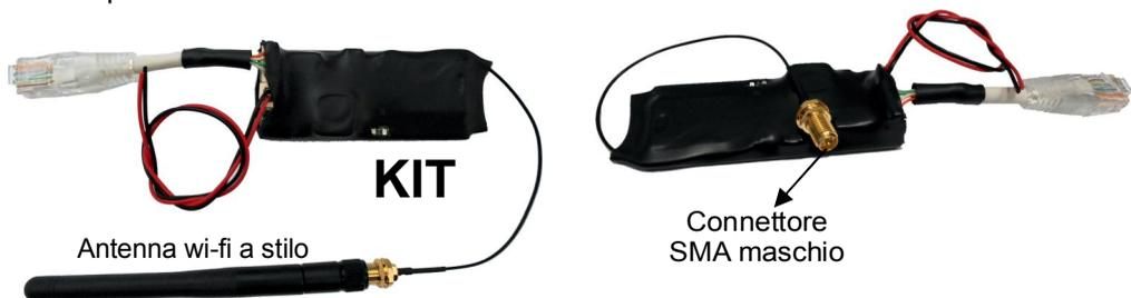
Tale soluzione, rispetto a quella standard, è particolarmente indicata quando il contenitore che alloggia la scheda universal wi-fi è di tipo metallico e/o non consentirebbe alla stessa di ottenere un sufficiente segnale radio per raggiungere l'access point e mantenere una costante stabilità di comunicazione.
