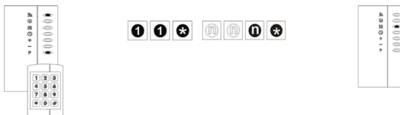
Figura 4: Impostazione della temporizzazione d'apertura
