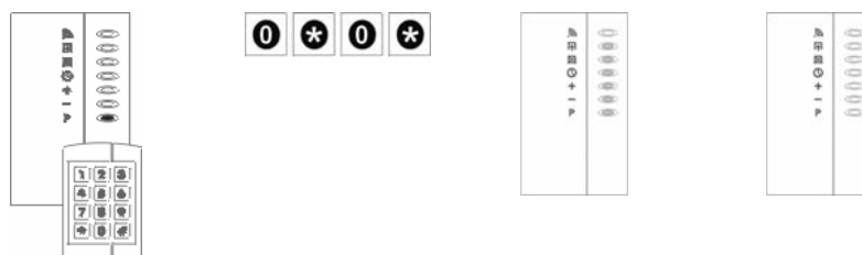
Figura 8: Impostazione modo stand-by utente
