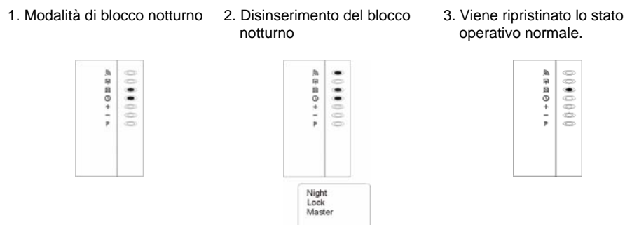
Figura 16: Accesso con la matrice di blocco notturno
