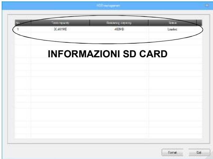
Utilizzare SD card di qualità e con tempi di scrittura veloci. Sono supportate SD card fino a 128GB. Effettuare una formattazione completa della SD card da questa pagina prima del suo utilizzo.
