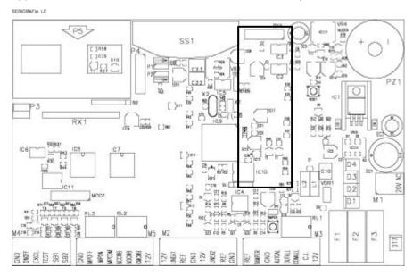
Le uscite sono comandabili mediante uno o più telecomandi programmati come panico (sirena AUTOAL, OUTALL), medico (RL1), rapina (RL3) o allarme tecnicomancanza rete (RL4) durante la fase di acquisizione secondo le modalità riportate sul manuale installatore a pag. 8.
